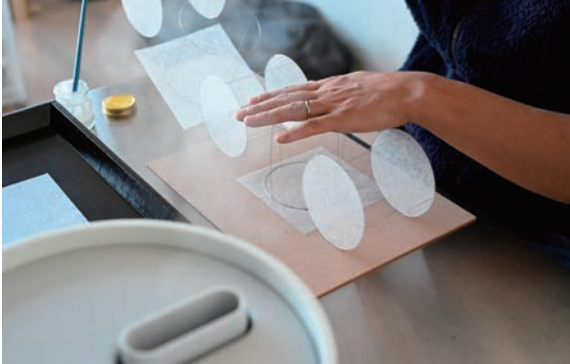
極細のステンレスの枠に、極薄の典具帖和紙を貼り付けていく。
